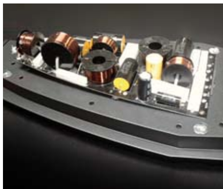
Viele Bauteile und allesamt von bester Güte: quasi-6-dB-Weiche der GamuT M'inenT 5.
