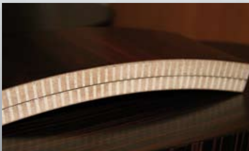
Die MDF-Platten sind geschlitzt und so leicht zu biegen. Die Fugen werden mit Klebstoff gefüllt.
